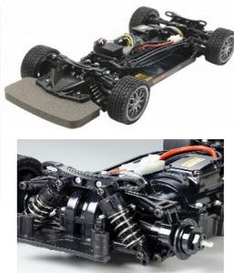
La classica sportiva della casa Giapponese viene abbinata al collaudatissimo telaio 4WD TT-02 con trasmissione cardanica di semplice costruzione e limitata manutenzione. La carrozzeria della Evo V nella configurazione stradale è fedelmente riprodotta in policarbonato trasparente con parti separate per alettone e specchietti. Il telaio TT-02 dispone di 4 sospensioni a doppio braccio indipendenti ed ammortizzatori a frizione. Una vasta serie di Optional permettono la personalizzazione del modello.
