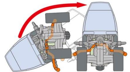
Tamiya ha il piacere di presentare un nuovo concetto per i modelli RC da divertimento. La Dancing rider utilizza il nuovo telaio T3-01, 2 ruote motrici, concepito come veicolo a tre ruote dotato di due sezioni snodate che permettono l'inclinazione del modello per sterzare. Una speciale barra fissata al servocomando dello sterzo permette di raddrizzare il modello quando si ribalta su un fianco. La Dancing Rider vi offrirà il massimo divertimento e autonomia di funzionamento elevatissima.
