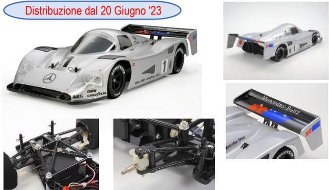
Nuova produzione per storica Mercedes C11 che ha partecipato alle gare di durata negli anni 90. Il kit in scala 1:10 utilizza il telaio 2WD con trasmissione diretta. La carrozzeria è fedelmente riprodotta in policarbonato trasparente. Include motore Sport Tuned, impianto RC venduto separatamente.
